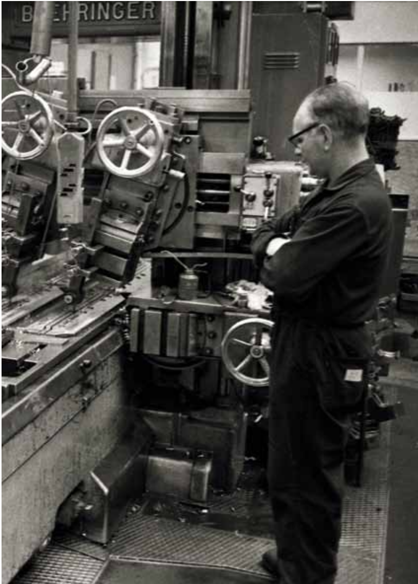
En arbeider ved NEBB i Oslo overvåker en automatisert shapingsmaskin, 1972.
