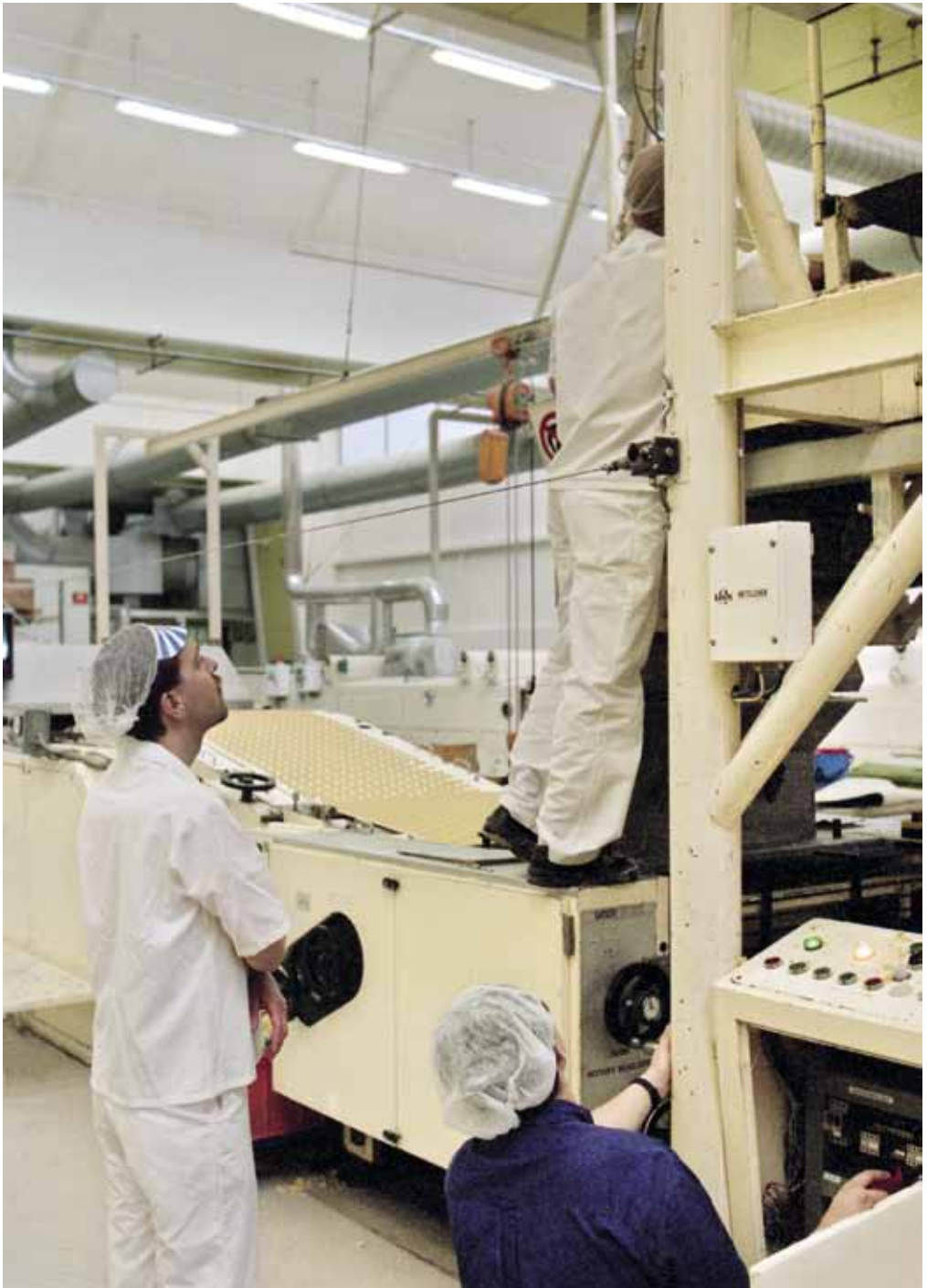
Når prosessen ikke løper som den skal blir det hektisk i bakeriet. Bakerne og mekanikeren fra verkstedet (blå kjeledress) arbeider med å rette feil i deigfordeleren. FOTO: RODERICK T. EWART/AKERSHUSMUSEET
